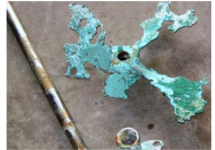
**ELECTROLYTIC (ELECTROLYSIS) OR STRAY CURRENT CORROSION**
